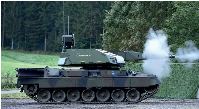
Bild 13 Der Flugabwehrturm Skyranger 35 auf einem älteren Leopard 1 Fahrgestell.
