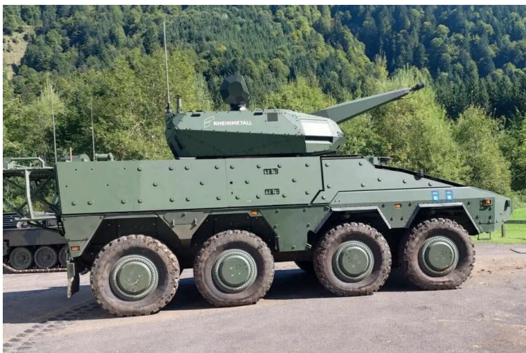
Bild 6 Der Turm Skyranger mit integrierter Small Anti Drone Missile Abschussvorrichtung
