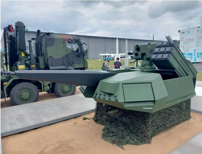
**Bild 2 Der Turm Skyranger mit integrierter Small Anti Drone Missile Abschussvorrichtung**
